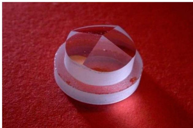
Figura 1. Sensore di fronte d'onda piramidale.
